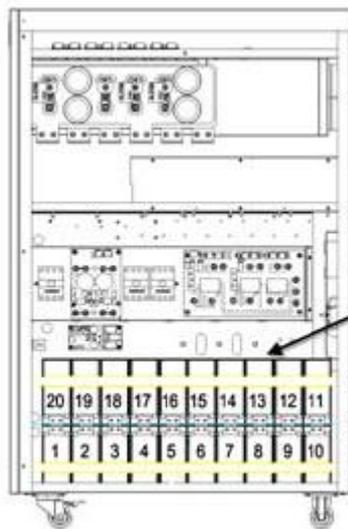
Соединение теплового датчика аккумулятора
