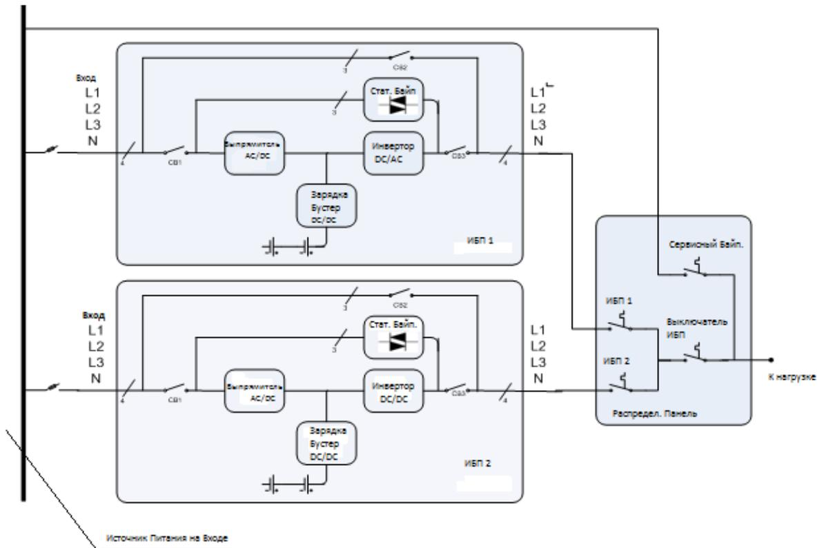
В ходе параллельной работы, входы и выходы приборов в количестве более одного соединяются друг с другом. Но, группа аккумуляторов каждого прибора непременно должна быть отдельной. Аккумуляторы не используются совместно. При размещении приборов в параллельной системе и выполнении электрических соединений необходимо принять во внимание следующие нюансы:
